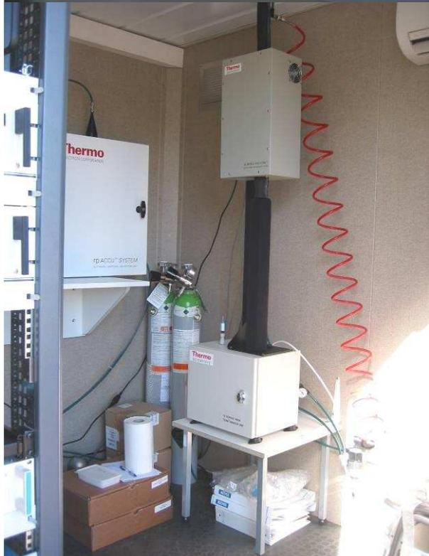
*Le module FDMS et sa tête de prélèvement de particules PM10 (station du Faubourg Blanchot)*
